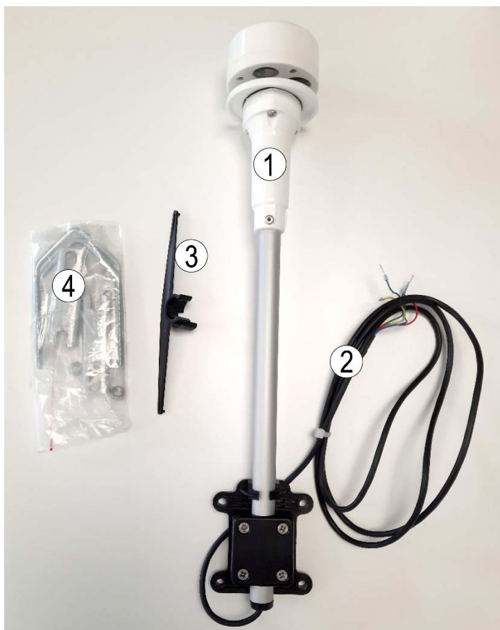
(1) Anémomètre, (2) câble, (3) mire d'alignement, (4) système de fixation sur mât
