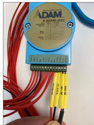
Figure 3-3 – Câblage RS485 côté ADAM
