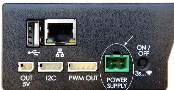
Figure 2-12 – Branchement du connecteur 2 points à l'entrée 8-30 VDC de l'IQ-LINK
