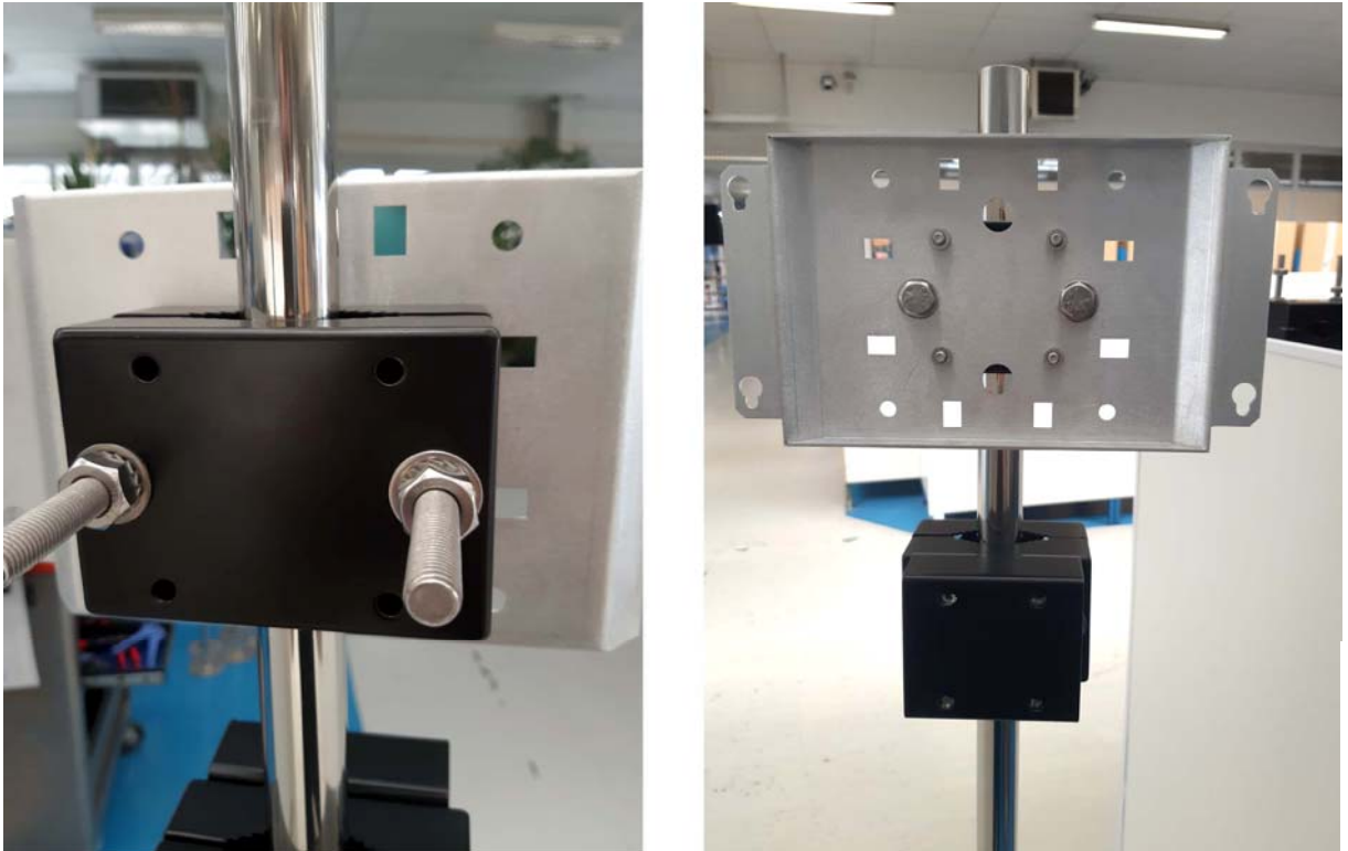
Figure 2–13 – Fixation du support CAIRNET DATA+ sur le mât du trépied
