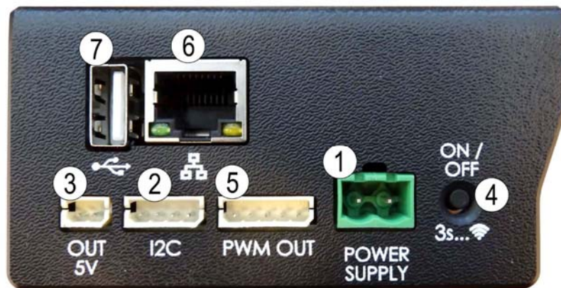
Figure 1-5 – Connexions sur la face supérieure de l'IQ-LINK
