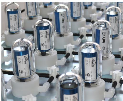
\* Cairsens® sont fabriqués en France et étalonnés au sein de notre laboratoire métrologique selon les standards de référence AQMS. Ils sont livrés avec un certificat d'étalonnage. Aucune maintenance ou re-étalonnage ne sont nécessaires pendant l'année de garantie.
