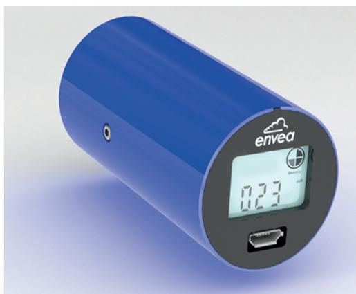
La plupart des capteurs Cairsens® utilisent la technologie ampérométrique qui consiste en trois électrodes : l'électrode de travail (anode), la contre-électrode (cathode) et une électrode de référence. Le gaz à analyser est diffusé au travers d'une membrane perméable vers l'électrode sensible. La fonction du gaz, l'oxydation a lieu à l'anode, ou la réduction à la cathode. Le signal électrique généré entre les deux électrodes est proportionnel à la concentration
