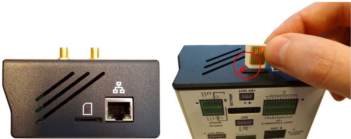
Indication du sens d'insertion du détrompeur
