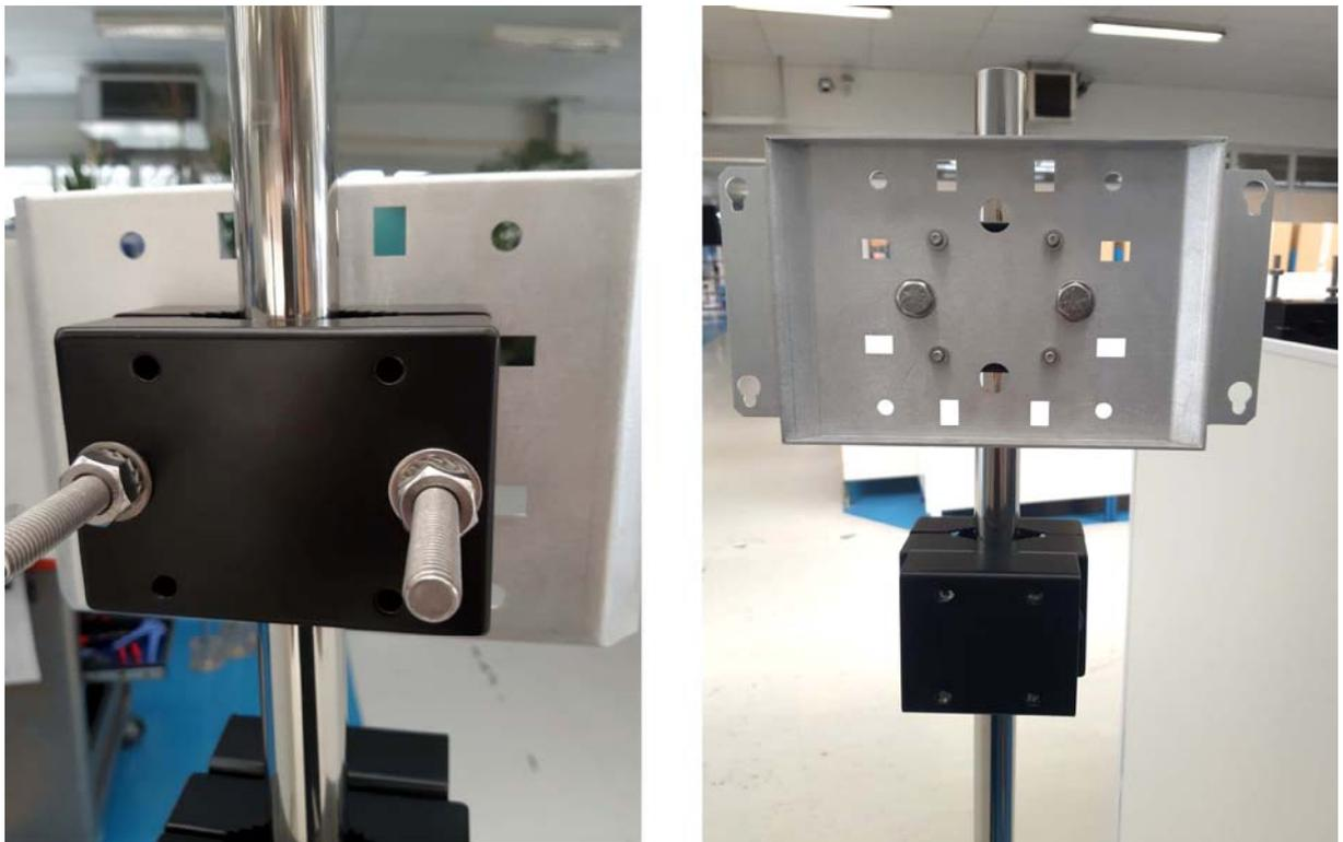
Figure 2–16 – Fixation du support CAIRNET et des panneaux solaires sur le mât du trépied
