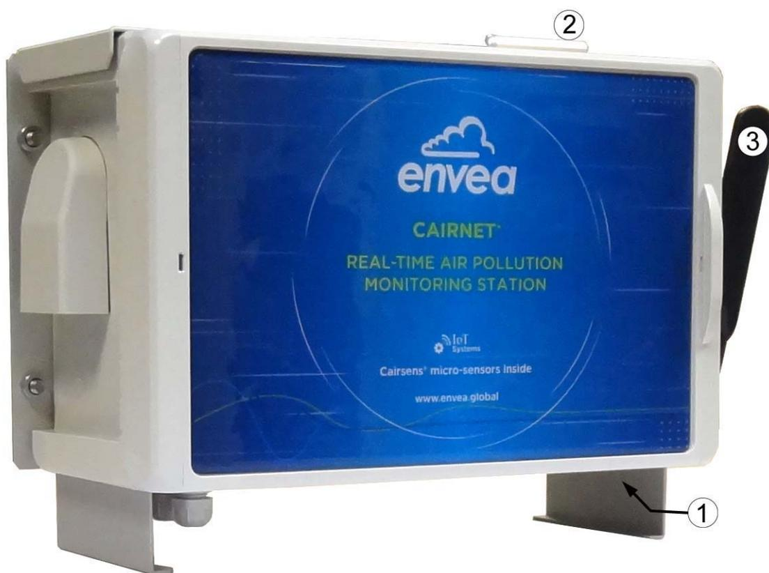
(1) Entrée du gaz échantillon, (2) extraction d'air, (3) antenne.
