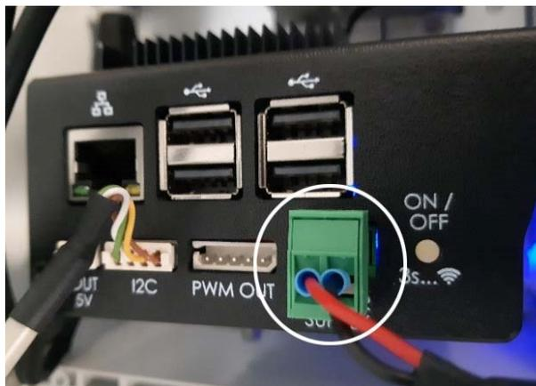
Figure 2-15 – Branchement du connecteur 2 points à l'entrée 8-30 VDC de l'IQ-LINK
